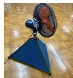
巨大扇風機 危険防止の囲い
